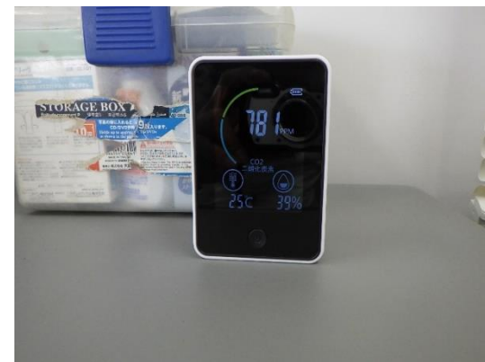
【現場事務所内に換気表示器の導入】
