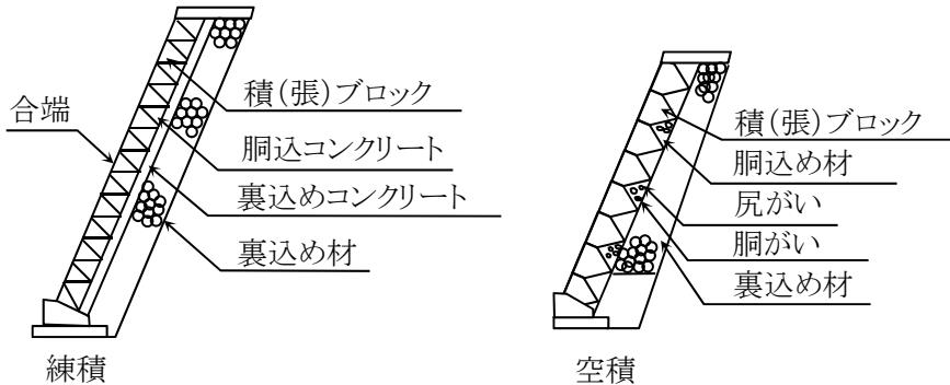
図3-2-5 コンクリートブロック工
