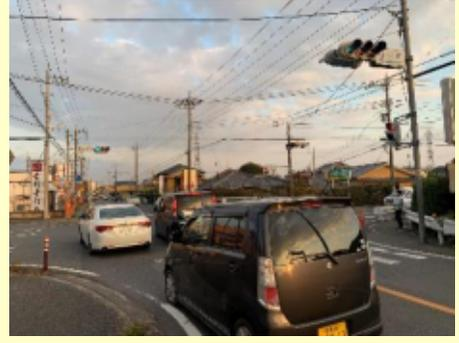
国道50号に右折車線が設置されていない。交差点内での追越しや、譲り合いで処理されている
