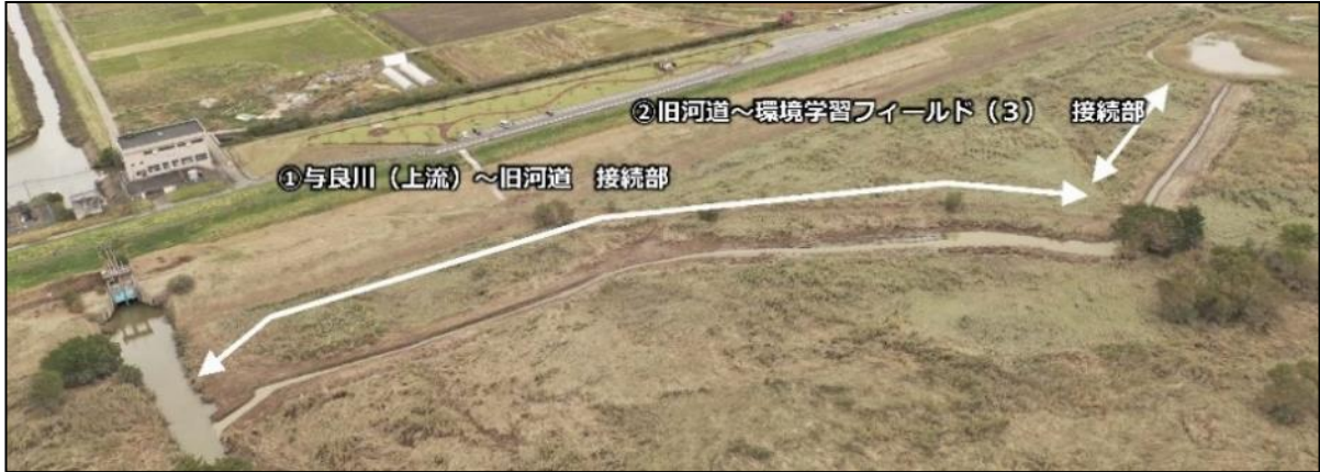
与良川ー与良川旧河道ー環境学習フィールドの簡易水路による接続 ※2
