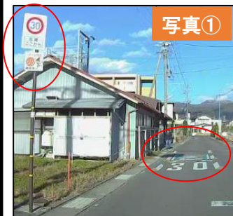
ゾーン30入口対策 (標識・路面標示)
