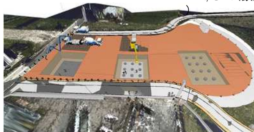
BIM/CIMデータを用いた施工手順の作成 (掘削・杭頭処理)
