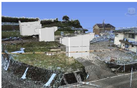
3DレーザースキャナーとBIM/CIM(橋梁下部モデル)の合成 (着手前)
