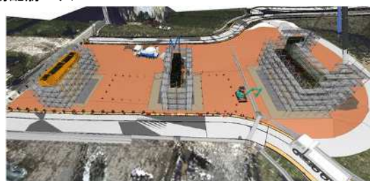
BIM/CIMデータを用いた施工手順の作成 (足場組立・型枠組立・生コン打設)
