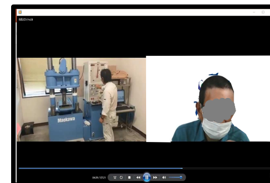
圧縮強度試験(コンクリート圧縮)
