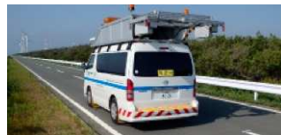
①舗装点検車により舗装の損傷状況を映像やレーダ等で調査
