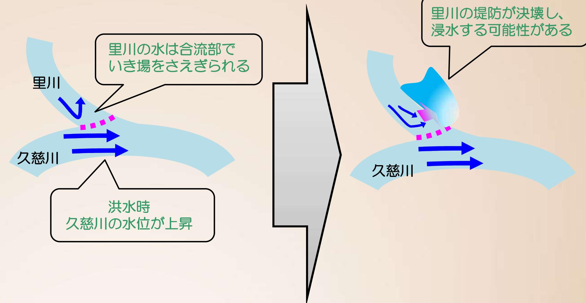
※バックウォーター現象とは 洪水時に久慈川(本川)の水位が高くなると、里川(支川)の水が合流部で行き場を失い逆流したり、支川の水位が上昇する現象。
