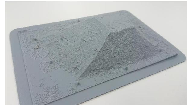
実証試験に使用した盛土の3D模型
