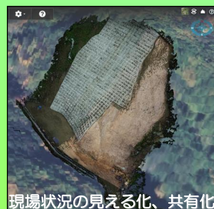
施工前後の3次元比較 による数量確認
