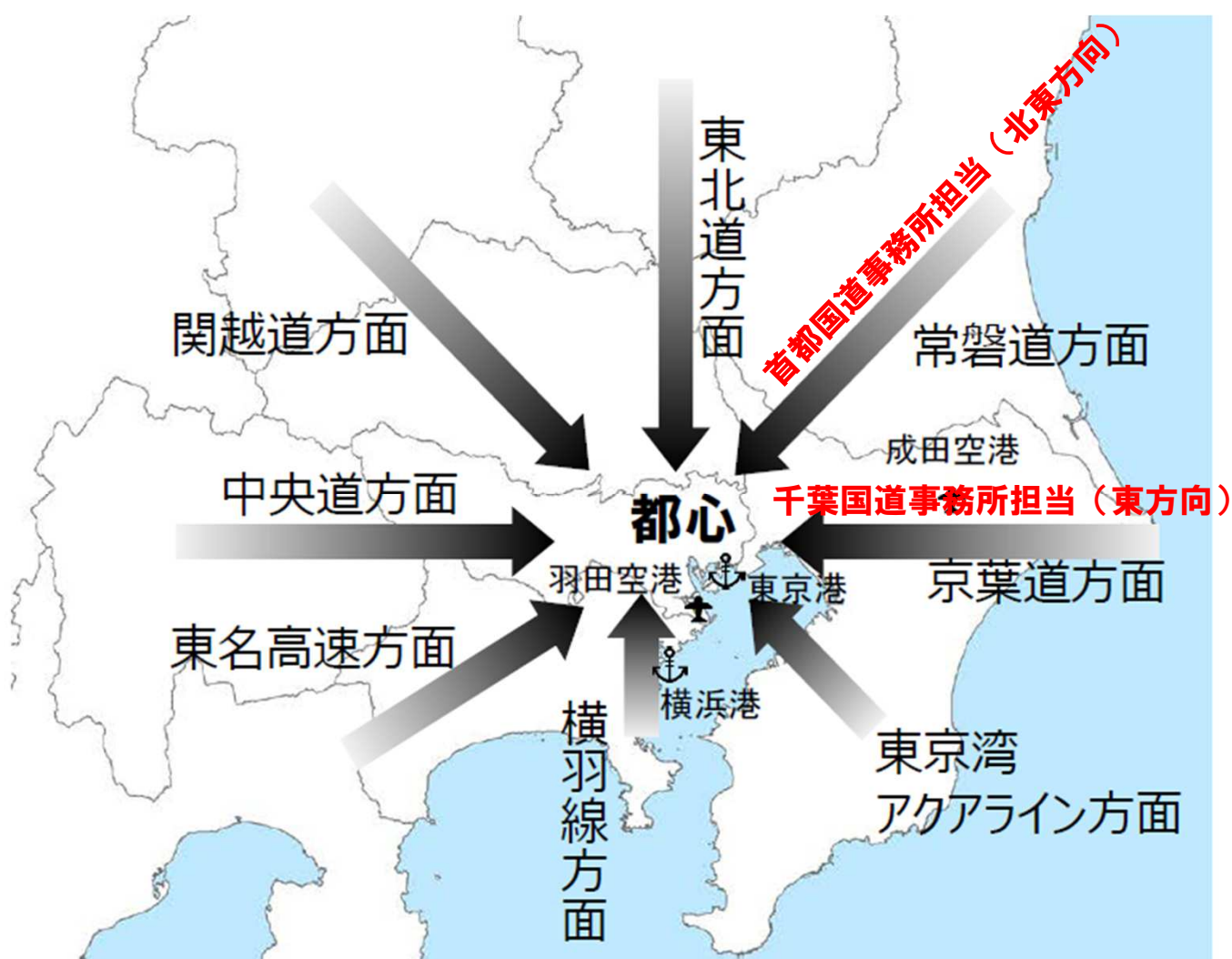
首都直下地震に備えた“八方向作戦”による道路啓開
