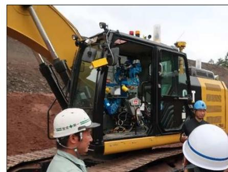
遠隔操作ロボットが操縦しています
