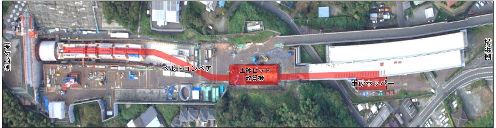
シールドマシン2号機 現場設備計画（横浜坑口）
