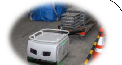
資機材を牽引するロボット
