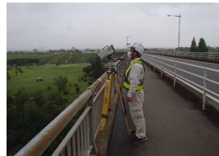
治水橋(荒川)水位・流量観測所における非接触型流速計による試験状況
