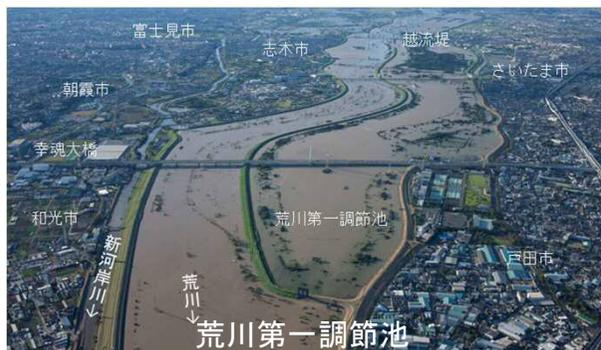
荒川第一調節池において、約3,500万m3の洪水を貯留し、岩淵地点での水位を約30~40cm低下させたと推定
