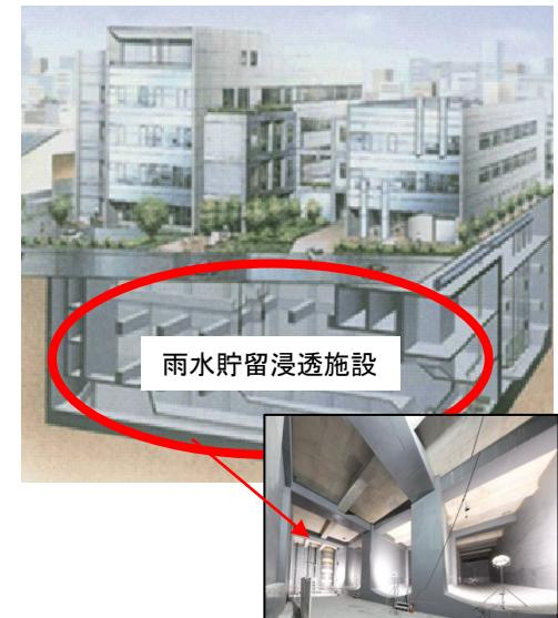
雨水貯留浸透施設の整備イメージ 21
