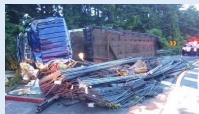
【特殊車両の重大事故事例】 無許可のセミトレーラ横転により、積荷が落下。約12時間の国道が通行止めとなった上、ガードレールや照明灯も損傷。
