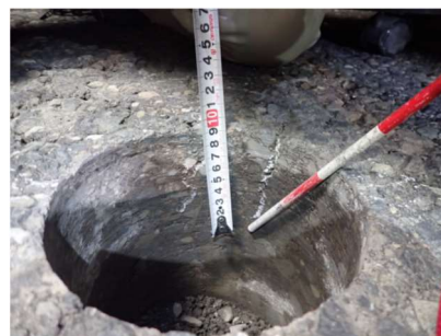
写真1 乾式によるコアの採取状況 図1 採取したコアの模式図
