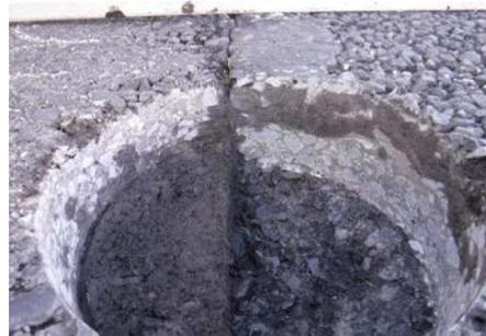
写真2 水の浸透状況(No.3)
