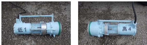
図-3 排水ポンプ (左：標準型 右：高揚程型)
