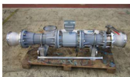
図-3 排水ポンプ (左：標準型 右：高揚程型)
