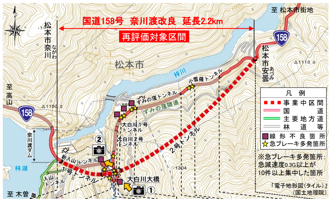
国道158号(現道)の線形不良箇所および急ブレーキ多発箇所
