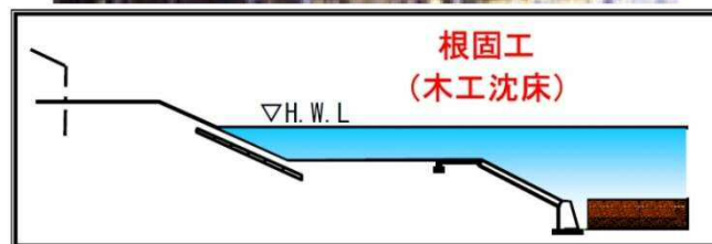
木工沈床による礫間浄化
