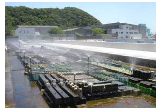
新素材の開発(港湾空港技術 研究所における曝露試験)
