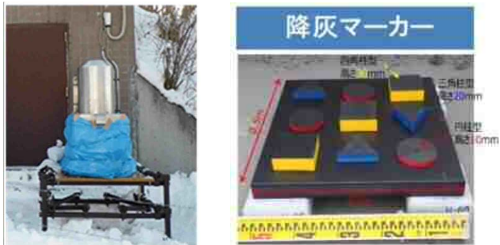
図 36 自動降灰量計（左）と降灰マーカー（右）
