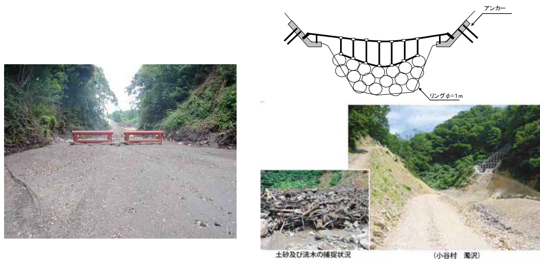
図 26 流木対策の事例（左：鋼製牛柵（新燃岳）、右：ワイヤネット）
