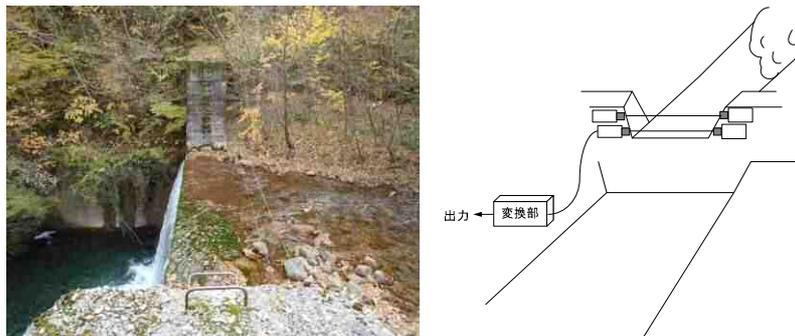
図 30 ワイヤセンサー設置イメージ
