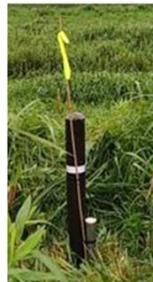
●堤防へ高密度に設置したセンサーが、越水や決壊箇所を検知し、情報を送信
