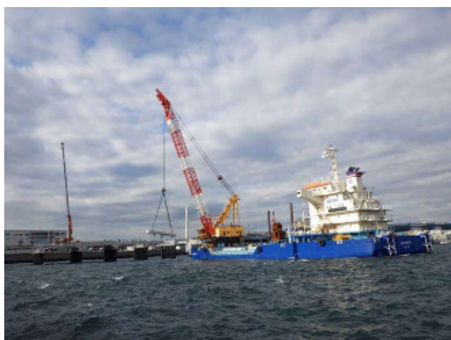
写真-1 多目的自航式起重機船 CP-5001の作業状況
