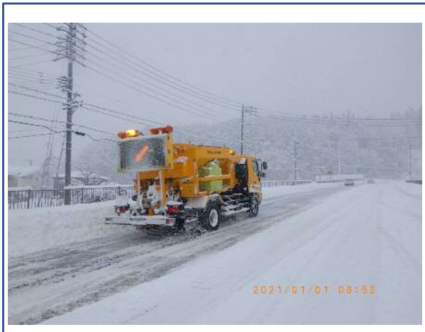
路面凍結防止剤散布作業
