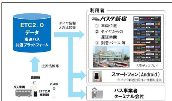
従来のバスロケは GPS を利用していたが、ETC2.0 バスロケは高速道路の ITS スポットで情報をやりとりする道路インフラを利用したバスロケ。GPS 情報と統合することで、高速道路と一般道の両方のバス位置情報を提供することが可能。
