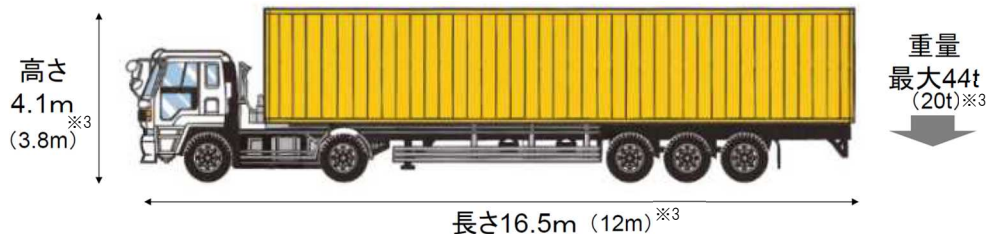
図 国際海上コンテナ車(40ft背高)の車両諸元値
