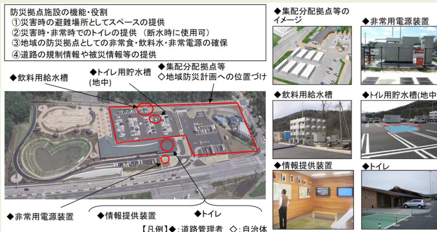
図 地域の防災拠点としての「道の駅」(みかも)
