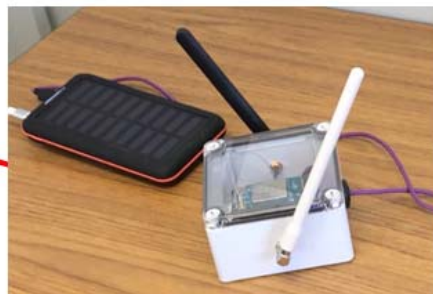
LoRa-LTEルータ設置
