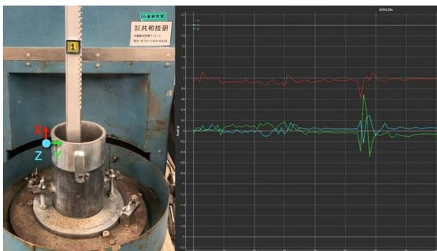
図4 締固め中におけるICタグによる加速度応答計測事例
