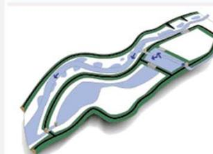
調節池排水門を閉め、調節池としての容量を確保します。昭和水門、さくらそう水門はサクラソウ自生地の冠水頻度を変えないために、洪水初期または小洪水時には開かれています。
