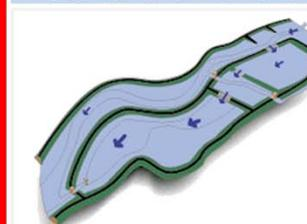
上流ブロックに流れ込んだ洪水流は上流ブロックを満たした後、次のブロックの入口である流入堤より貯水池(彩湖)ブロックへ流入し、所定の洪水調節が行われます。荒川の流量の低減に伴い、調節池の排水を行います。
