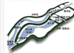
最下流の調節池排水門は開いており、貯水池「彩湖」の水位調節は、水位調節堰で行います。鴨川の荒川への合流は、昭和水門、さくらそう水門を開いておくことにより行います。
