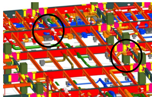
図3 干渉チェック(2-1)検討前 ※天井内機器設置困難、スリーブ貫通不可
