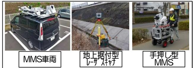
図-4 3次元レーザー計測機
