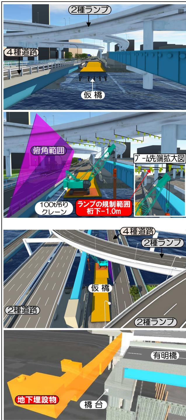
図-6 BIM/CIMモデル(下部構造施工時・地下埋設物)
