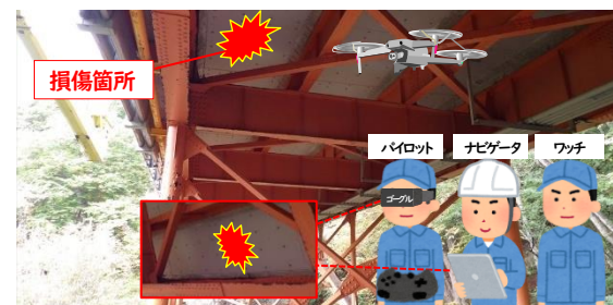
パイロットはFPV用ゴーグルなどを通して、ナビゲータは手元のタブレットを通して同じ映像を確認することができる。
