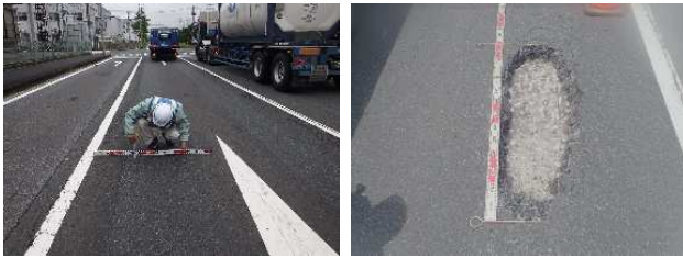
図-2 轍およびポットホール確認状況
