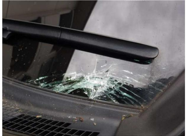
写真-4 枝落下による車両損傷状況
