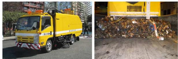
図-2 4輪ブラシ式の外観・塵埃回収状況・内部構造図
