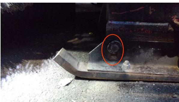
図-5 真空還流式吸込み口の高さ調整
