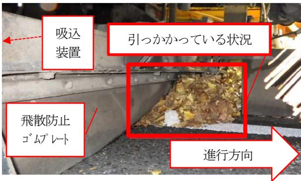
図-4 真空還流式ゴムプレートに落ち葉が引っかかる様子
