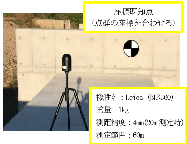
図3-1 レーザー測量の様子
