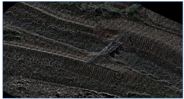
図-7 『Meta Shape』を用いてSfM解析を行い点群データ取得
