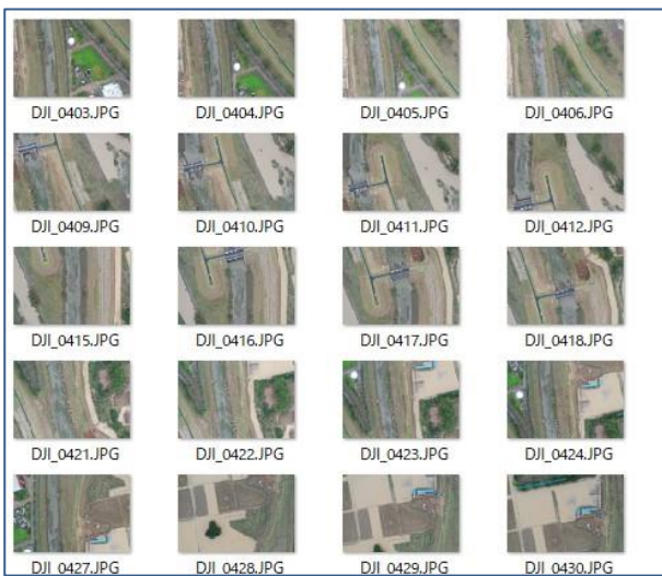
図-6 ラップ率を意識した垂直写真の撮影
