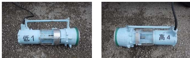
図-3 排水ポンプ (左：標準型 右：高揚程型)
