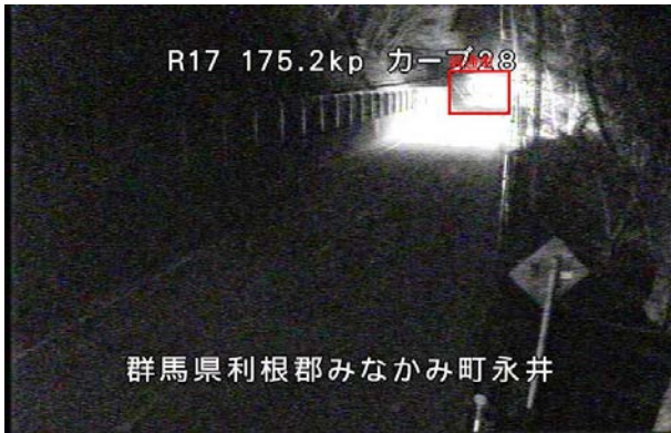
図-3 誤検知【夜間照明灯】
