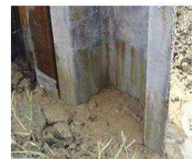
土木用摩擦低減材を塗布した場合
