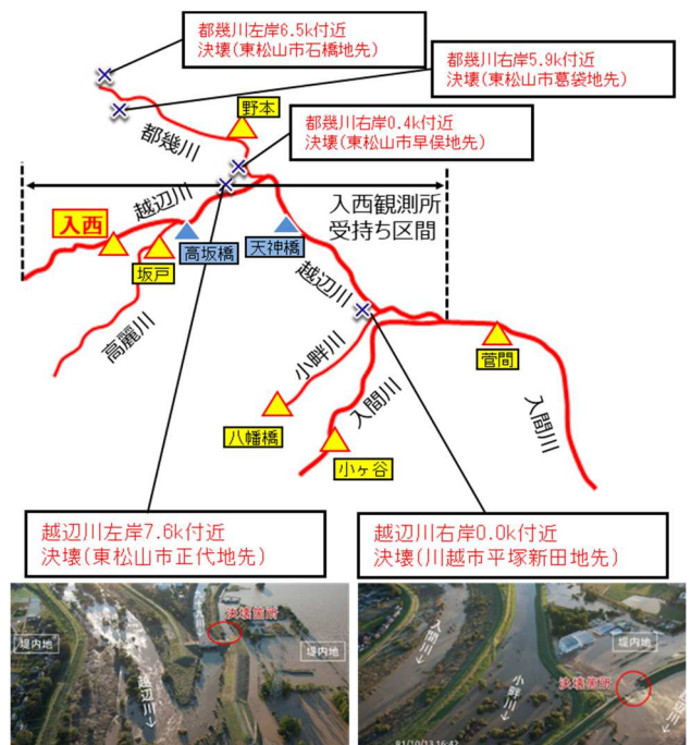
図-5 令和元年東日本台風に伴う堤防決壊状況
