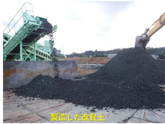
写真-5 回転式破砕機による改良土
