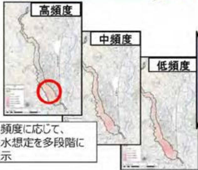
浸水の発生しやすさを示した重ね合わせ図
