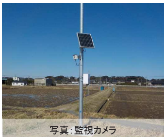
写真:危機管理型水位計・監視カメラの設置状況
