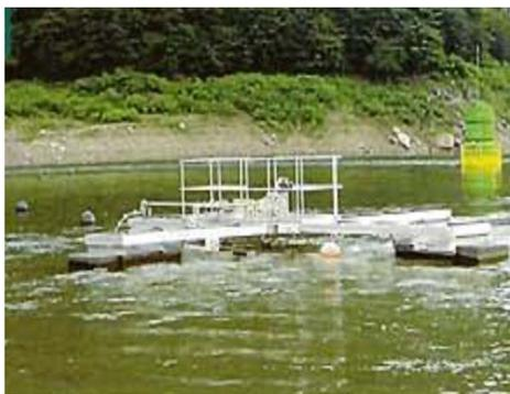
散気管式浅層曝気循環設備
